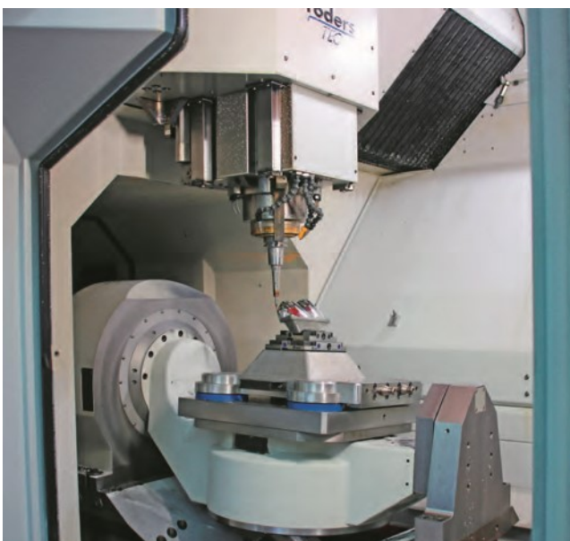
Hoch produktiv: Links ein Blick in den Arbeitsraum der RXU 100I, rechts eine Beispiel-Stahlform. (© Klaus Vollrath)
