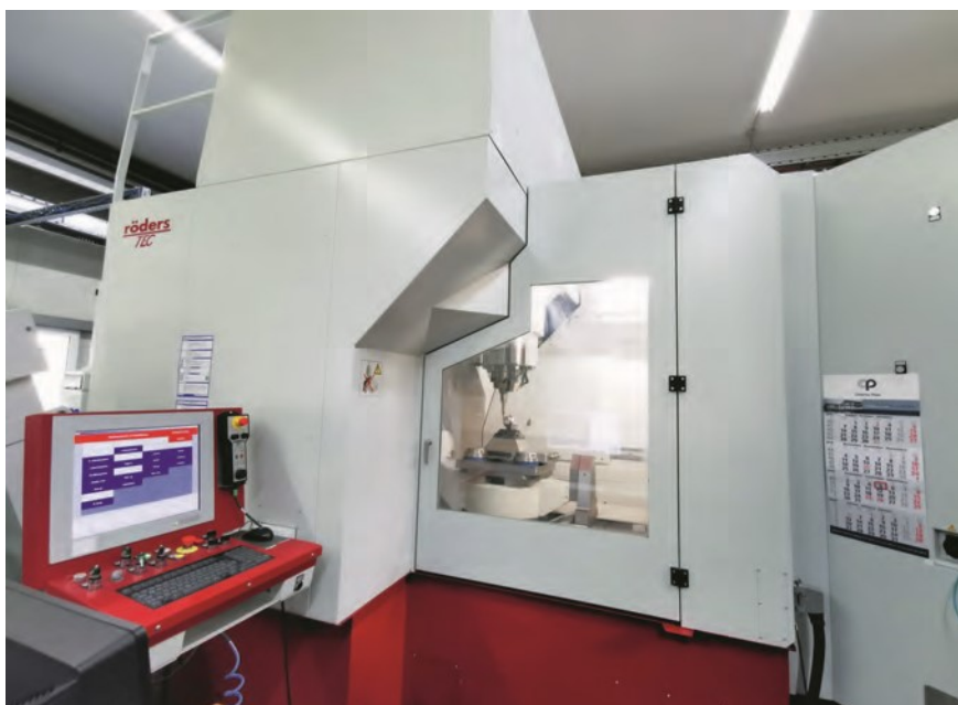
Flexibel: Die Rödgers RXU 1001 DSH ist sowohl für Schrump- als auch für Hochpräzisions-Jobs im Einsatz (© Klaus Vollrath)
