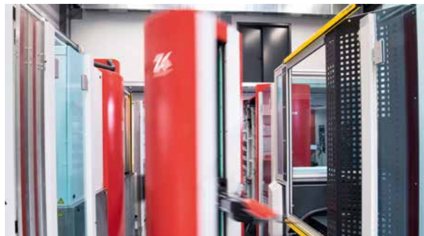
Die Automationslösung Chameleon der Firma Zimmer & Kreim ermöglicht den automatischen Wechsel von Elektroden und Bauteilen.
