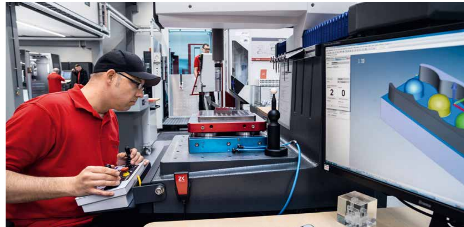
Die Messgeräte ZEISS CONTURA und ZEISS DuraMax (im Bild) messen hochgenau mitten in der Fertigungsumgebung. Dank der intuitiven Bedienerfreundlichkeit der Software ZEISS CALYPSO preset können auch alle Bediener problemlos den Versatz von Elektroden und Werkstücken messen.
